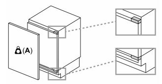
Les façades d'appareils montés qui dépassent le poids autorisé peuvent provoquer des dommages et entraîner un dysfonctionnement des charnières
