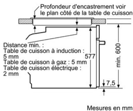
Si l'appareil est installé sous une table de cuisson, les épaisseurs de plaque de travail suivantes (le cas échéant y compris la sous-structure) doivent être respectées.
